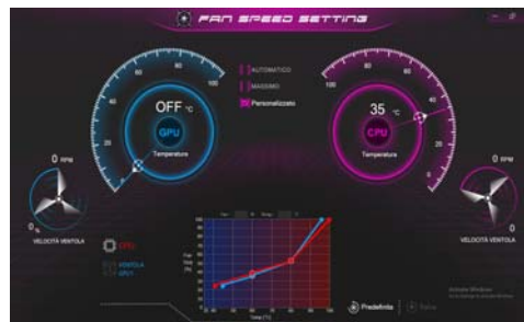
Figura 8 - Controllo della velocità del VENTOLA
