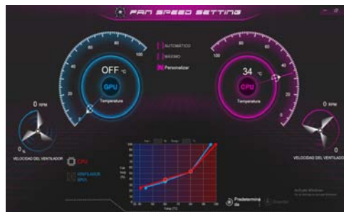
Figura 8 - Control de velocidad de FAN
