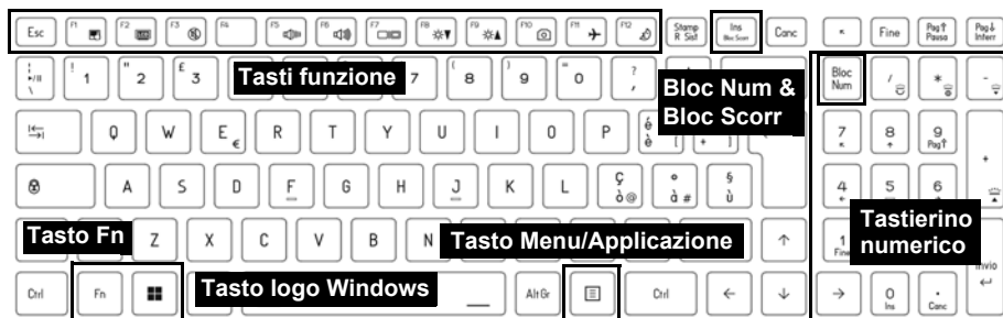
Figura 3 - (Opzione di fabbrica) Tastiera con LED bianchi a pieno formato
