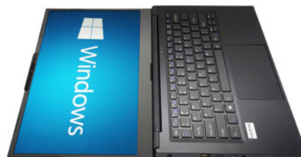
Figure 4 - Panneau LCD ouvert à 180 degrés avec écran pivoté
