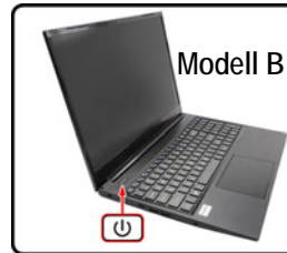
Abb. 1 Öffnen des Dekfels/LCD/Com- puters mit ange- schlossenem AC/ DC-Adapter
