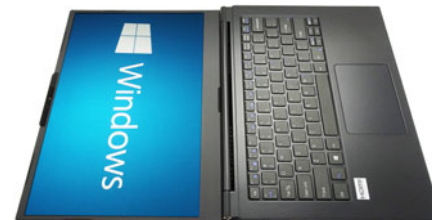
Abb. 4 - LCD-Bildschirm, der bei gedrehtem Bildschirm um 180 Grad geöffnet ist
