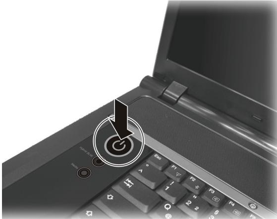
3. Jedesmal, wenn der Computer eingeschaltet wird, führt er einen Einschaltselbsttest (POST) aus. Wenn das POST seinen Test erfolgreich beendet, erzeugt der Computer einen Signalton und das Betriebssystem, z.B. Windows, fährt sich hoch.
