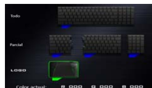
Figura 24 Secciones del teclado y del LED del logotipo de la tapa superior
