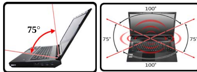
Figura 17 - Emisor - Ángulos de visión
