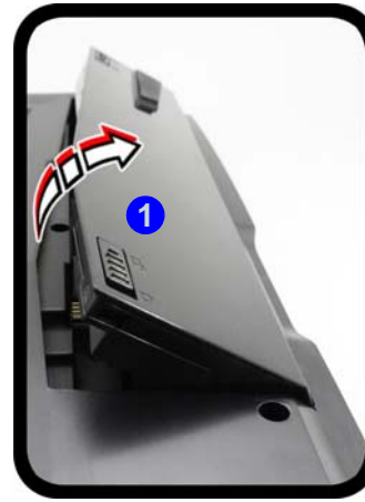
Figure 26 - Retirer la batterie et insérer la carte USIM
