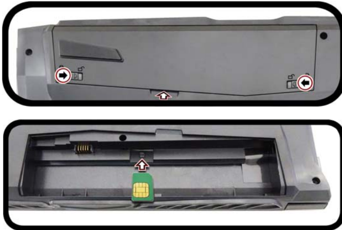
Abb. 26 - Herausnehmen des Akkus und einsetzen der USIM-Karte
