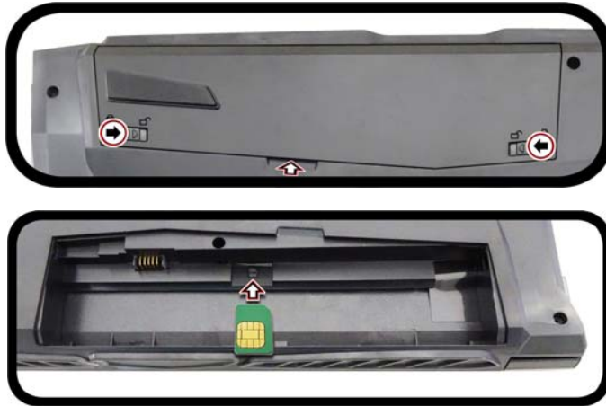
Figure 26 - Retirer la batterie et insérer la carte USIM
