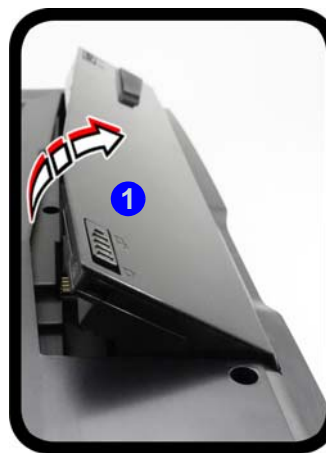
Figura 26 - Quitar la batería e insertar la tarjeta USIM
