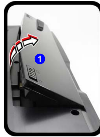
Abb. 26 - Herausnehmen des Akkus und einsetzen der USIM-Karte
