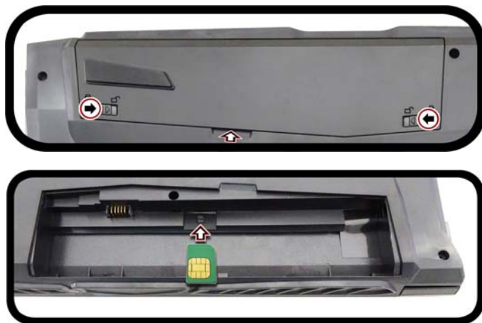
Figura 26 - Quitar la batería e insertar la tarjeta USIM
