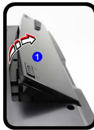
Figura 26 - Rimozione della batteria e inserimento della carta USIM
