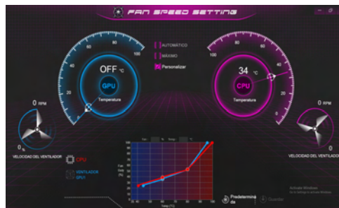
Figura 8 - Control de velocidad de FAN
