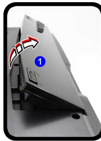
Abb. 27 - Herausnehmen des Akkus und einsetzen der USIM-Karte
