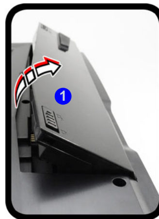
Figura 30 - Rimozione della batteria e inserimento della carta USIM
