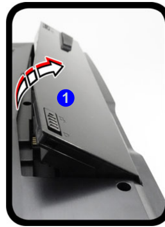
Abb. 30 - Herausnehmen des Akkus und einsetzen der USIM-Karte
