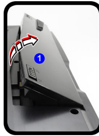
Figure 30 - Retirer la batterie et insérer la carte USIM
