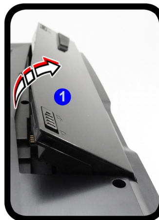
Figure 27 - Retirer la batterie et insérer la carte USIM
