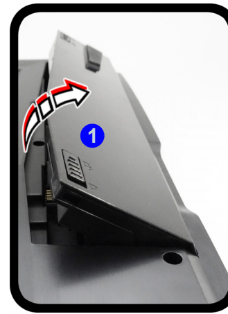
Abb. 27 - Herausnehmen des Akkus und einsetzen der USIM-Karte
