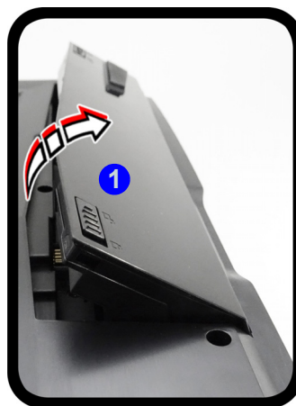
Figura 27 - Quitar la batería e insertar la tarjeta USIM
