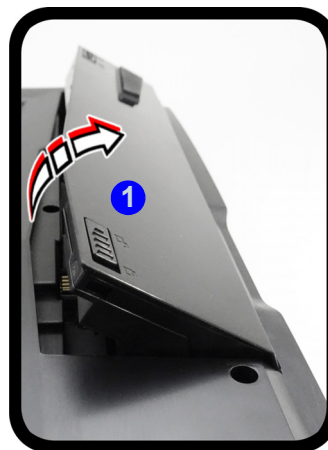
Figura 27 - Rimozione della batteria e inserimento della carta USIM
