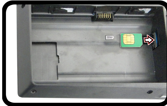
Abb. 32 - Herausnehmen des Akkus und einsetzen der USIM-Karte
