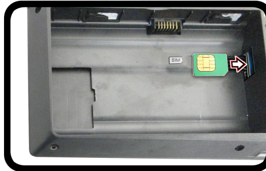
Figura 32 - Quitar la batería e insertar la tarjeta USIM
