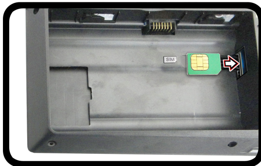
Figura 32 - Rimozione della batteria e inserimento della carta USIM
