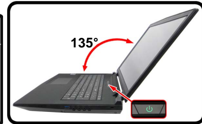
Abb. 1 - Öffnen des Deckels/LCD/Computers mit angeschlossenem AC/DC-Adapter
