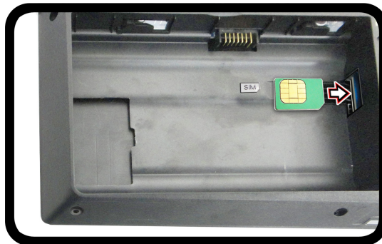
Figure 32 - Retirer la batterie et insérer la carte USIM
