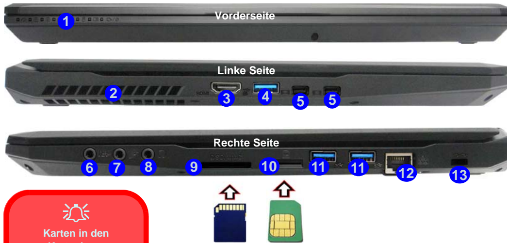
Abb. 14 - Ansicht von vorne, links und rechts (Modell A)
