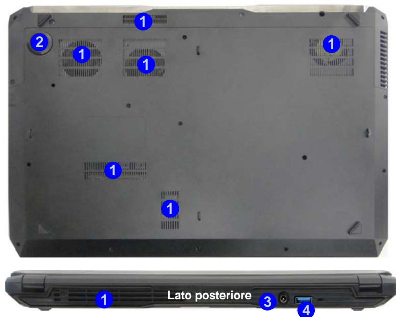
Figura 17 - Vista inferiore e posteriore (Modello B)
