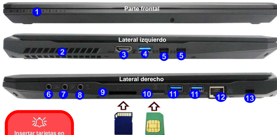
Figura 14 - Vistas frontal, izquierda y derecha (Modelo A)
