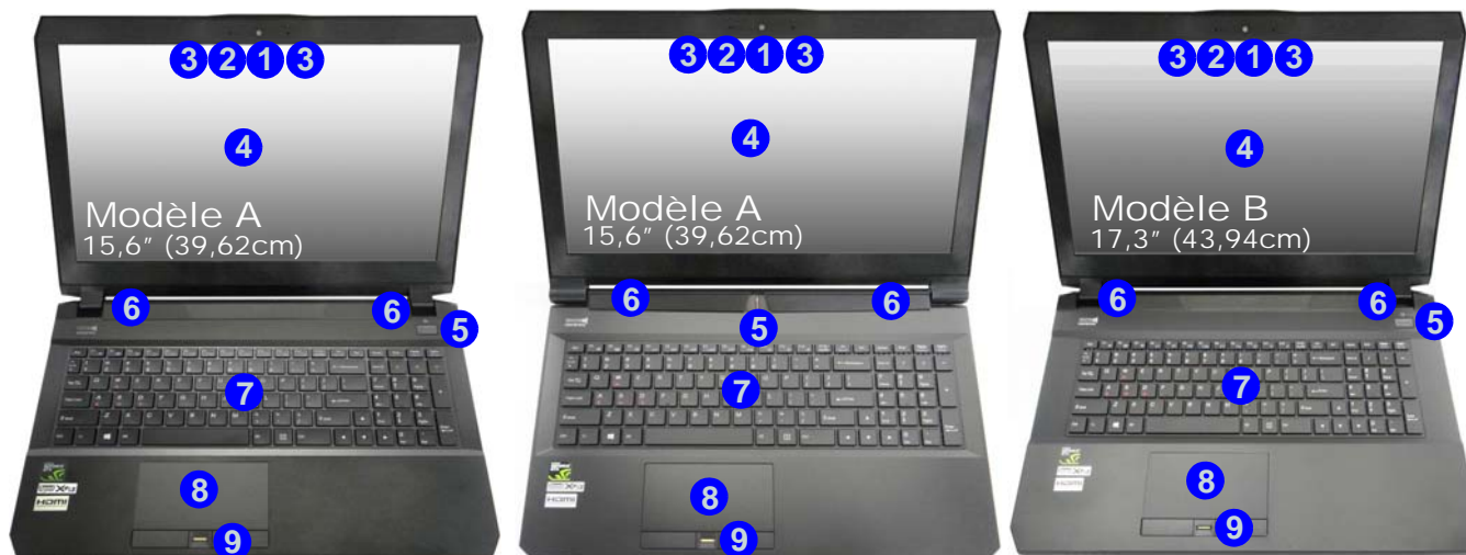
Figure 4 - Vue de face avec l'écran LCD ouvert (Modèles A & B)
