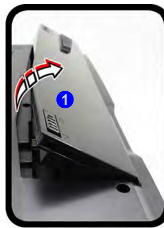
Figura 28 - Rimozione della batteria e inserimento della carta USIM
