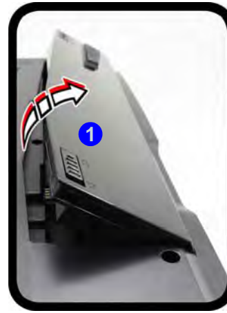
Figure 28 - Retirer la batterie et insérer la carte USIM
