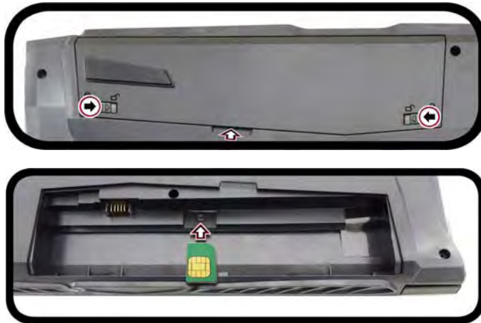
Figura 28 - Quitar la batería e insertar la tarjeta USIM
