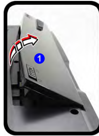
Abb. 28 - Herausnehmen des Akkus und einsetzen der USIM-Karte
