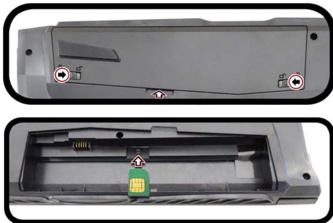
Figure 33 - Retirer la batterie et insérer la carte USIM
