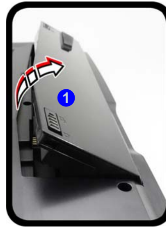
Abb. 33 - Herausnehmen des Akkus und einsetzen der USIM-Karte
