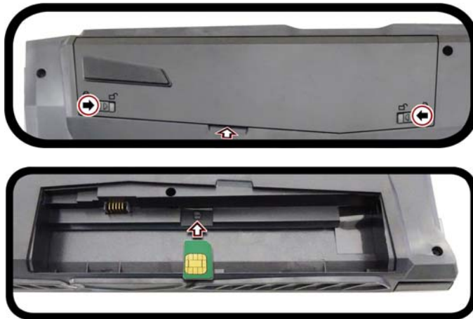
Figura 33 - Rimozione della batteria e inserimento della carta USIM
