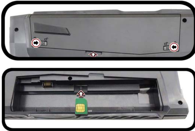
Abb. 33 - Herausnehmen des Akkus und einsetzen der USIM-Karte
