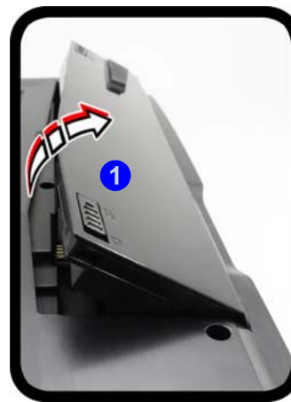
Figure 33 - Retirer la batterie et insérer la carte USIM
