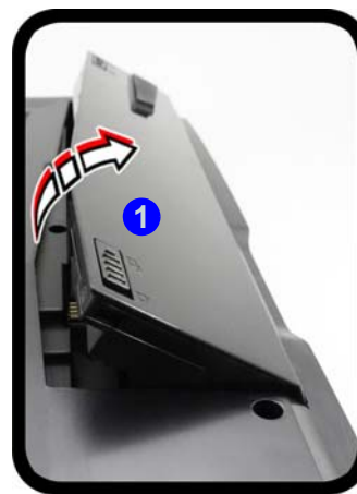
Figura 33 - Quitar la batería e insertar la tarjeta USIM
