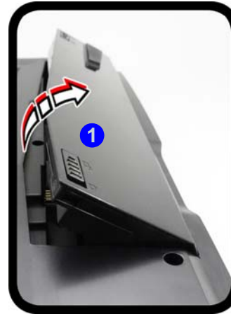
Figura 33 - Rimozione della batteria e inserimento della carta USIM
