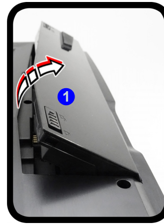
Abb. 31 - Herausnehmen des Akkus und einsetzen der USIM-Karte
