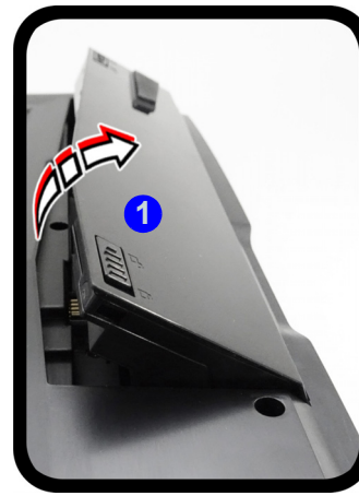
Figure 31 - Retirer la batterie et insérer la carte USIM
