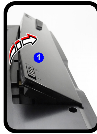
Figura 31 - Rimozione della batteria e inserimento della carta USIM
