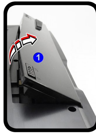
Figura 31 - Quitar la batería e insertar la tarjeta USIM
