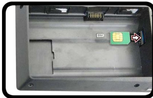
Figure 34 - Retirer la batterie et insérer la carte USIM
