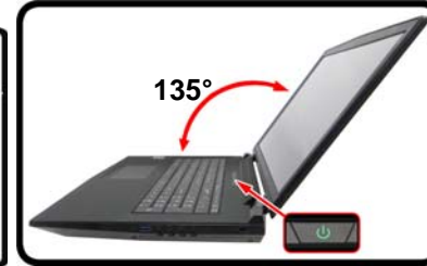
Abb. 1 Öffnen des Dekfels/ LCD/Com- puters mit ange- schlos- senem AC/DC- Adapter
