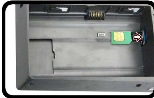
Abb. 34 - Herausnehmen des Akkus und einsetzen der USIM-Karte
