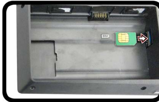
Figura 34 - Quitar la batería e insertar la tarjeta USIM
