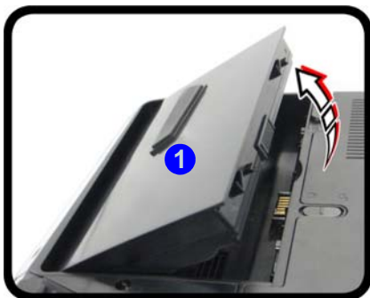
Figura 34 - Rimozione della batteria e inserimento della carta USIM
