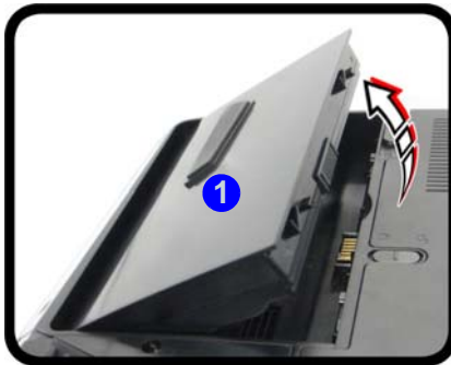
Abb. 34 - Herausnehmen des Akkus und einsetzen der USIM-Karte
