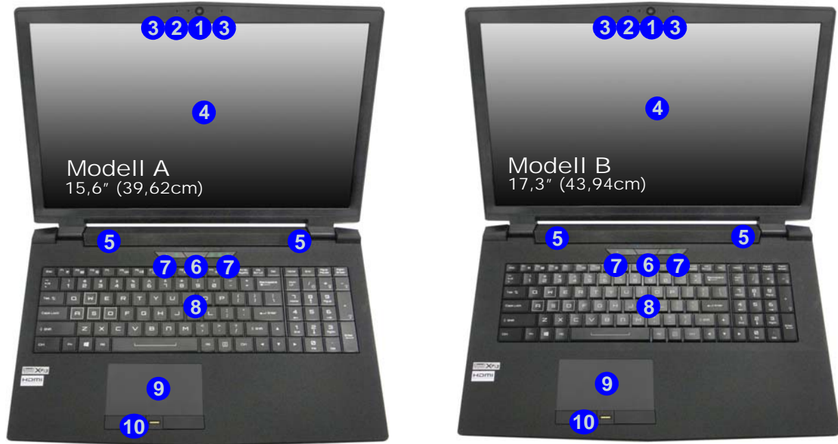
Abb. 5 - Ansicht von vorne mit geöffnetem LCD-Bildschirm (Modelle A & B)
