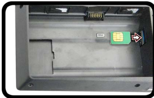
Figura 34 - Rimozione della batteria e inserimento della carta USIM
