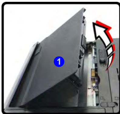
Figura 18 - Rimozione della batteria e inserimento della carta USIM
