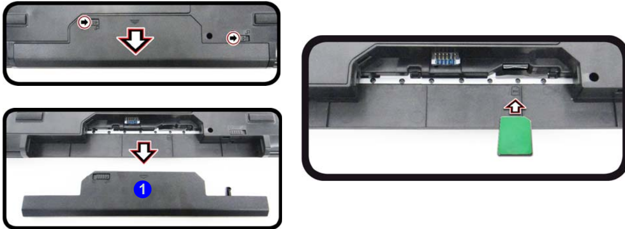
Abb. 14 - Herausnehmen des Akkus und einsetzen der USIM-Karte
