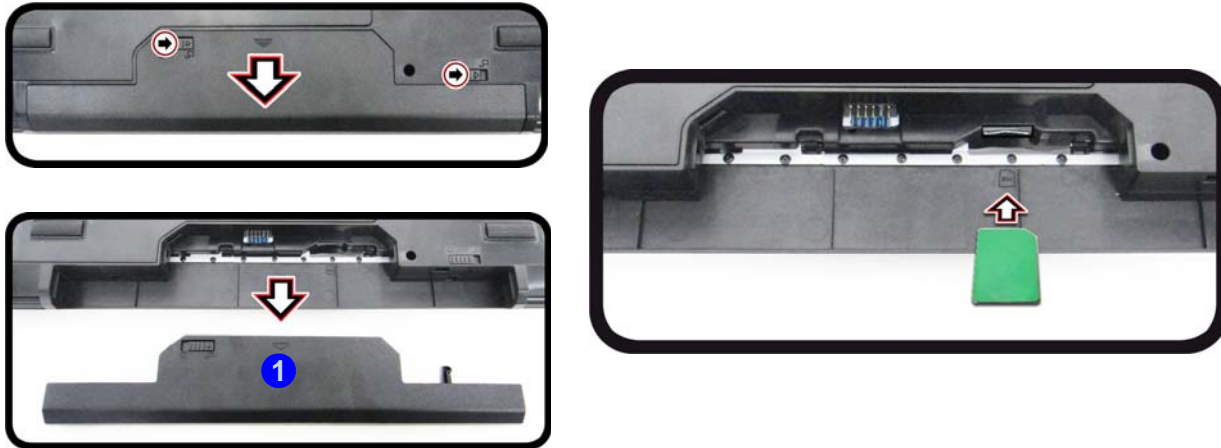
Figure 14 - Retirer la batterie et insérer la carte USIM
