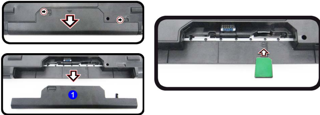
Figura 14 - Rimozione della batteria e inserimento della carta USIM
