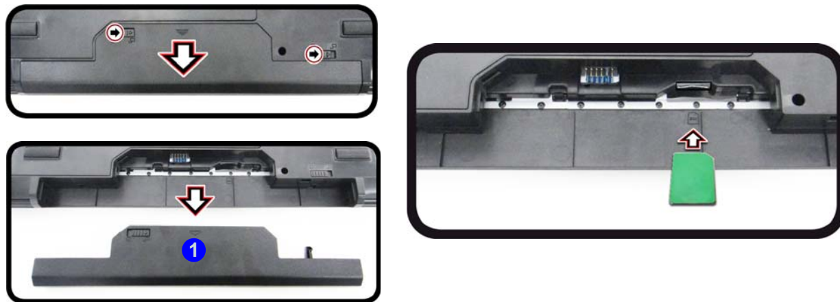
Figura 14 - Quitar la batería e insertar la tarjeta USIM
