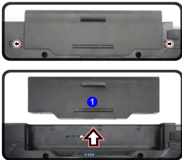
Figura 16 - Rimozione della batteria
