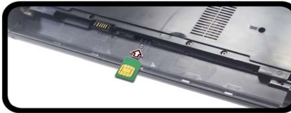
Abb. 15 - Herausnehmen des Akkus und einsetzen der USIM-Karte
