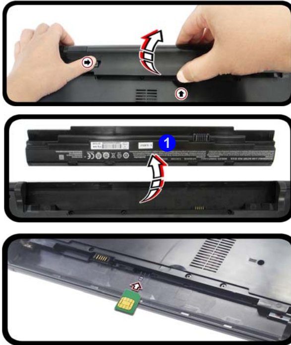
Figure 15 Retirer la batterie et insérer la carte USIM
