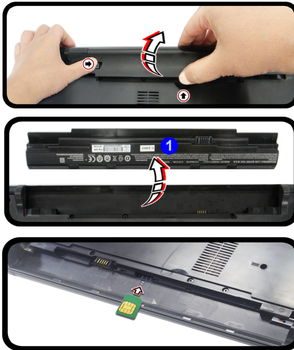
Figure 16 Retirer la batterie et insérer la carte USIM
