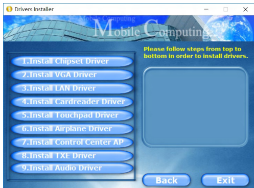
Figura 12 - Instalación de controladores
