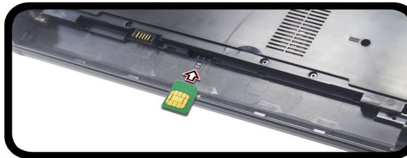
Abb. 16 - Herausnehmen des Akkus und einsetzen der USIM-Karte
