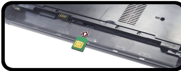
Abb. 15 - Herausnehmen des Akkus und einsetzen der USIM-Karte
