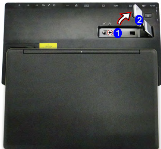
Figura 4 - Spostare il fermo per sbloccare il sistema
