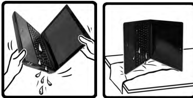
Figura 7 - Saque el líquido por el lado derecho y deje el ordenador apoyado sobre el lado derecho
