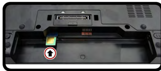
Figure 9 - Insérer la carte USIM
