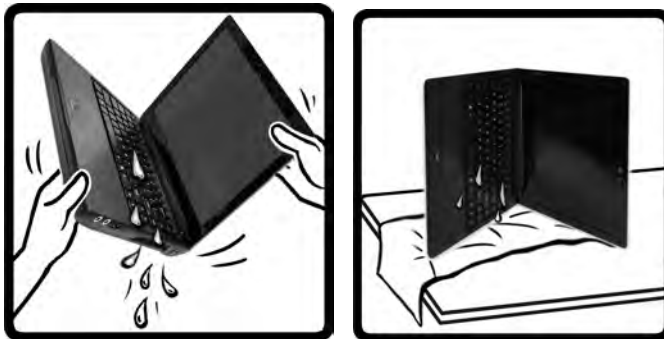
Figure 7 - Evacuez tout liquide par le côté droit et laissez l'ordinateur reposer sur le côté droit pour le faire sécher
