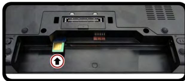
Figura 9 - Insertar la tarjeta USIM
