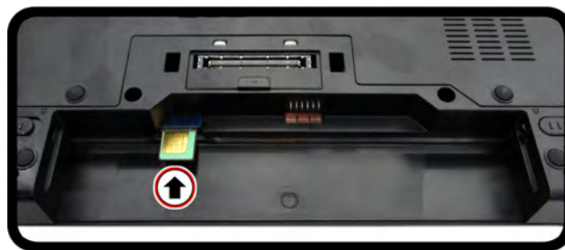
Figura 9 - Inserimento della carta USIM
