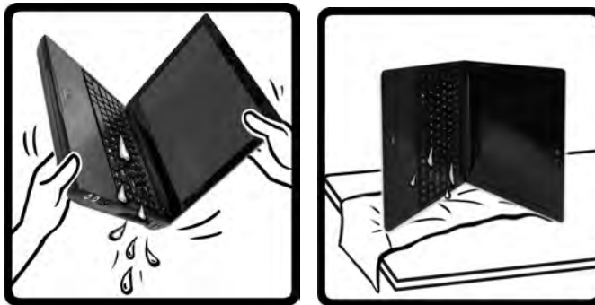
Figura 7 - Asciugare tutto il liquido sul lato destro e lasciarlo asciugare in piedi in questa posizione
