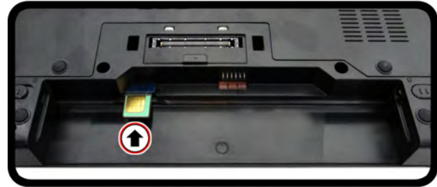
Abb. 9 - Einsetzen der USIM-Karte
