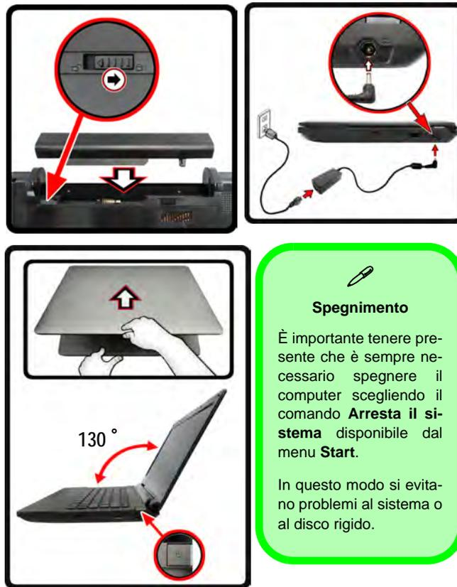
Figura 1 - Apertura del coperchio/LCD/Computer con alimentatore AC/DC collegato
