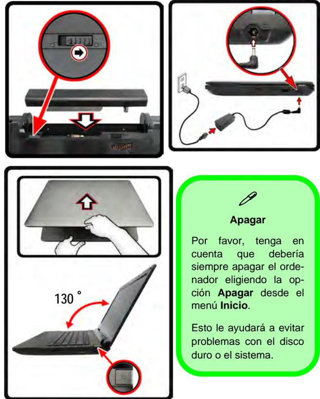
Figura 1 - Abrir la tapa/LCD/ordenador con el adaptador AC/DC enchufado
